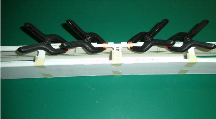
Weiter wird den Wagenboden an die beide Wagenenden verklebt laut die gewölbte Wagenboden-Führung.
