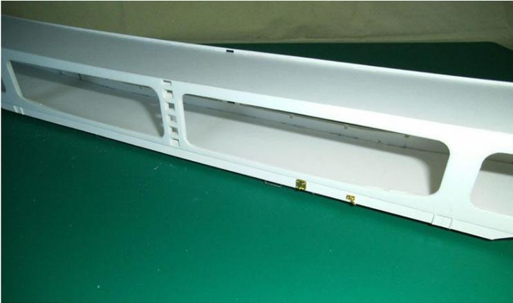
Die geätzten Führungsrillen werden gekantet.
